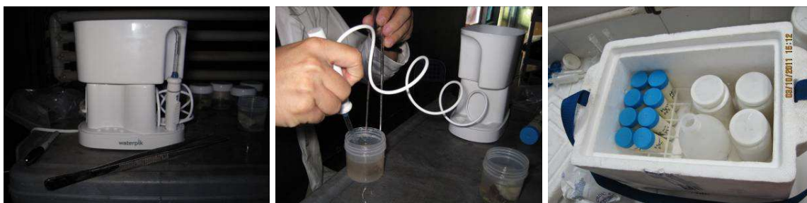
Figura 5. Izquierda: Waterpik empleado para la extracción de tejido coralino. Centro: proceso de extracción. Derecha: almacenamiento de muestras en nevera.
