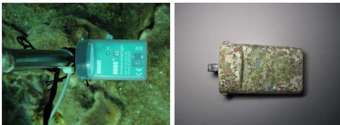
Figura 8. Dispositivos electrónicos HOBOS utilizados para la medición continua de la temperatura y la luminosidad en estaciones de monitoreo de arrecifes coralinos del SIMAC. Izquierda: dispositivo al momento de su instalación en el año 2009. Derecha: Dispositivo recolectado en el año 2010, totalmente colonizado por algas costrosas.
